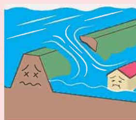
崩れた場所は一気に広がり、勢いよく水が流れ出し、家などに襲いかかります。
